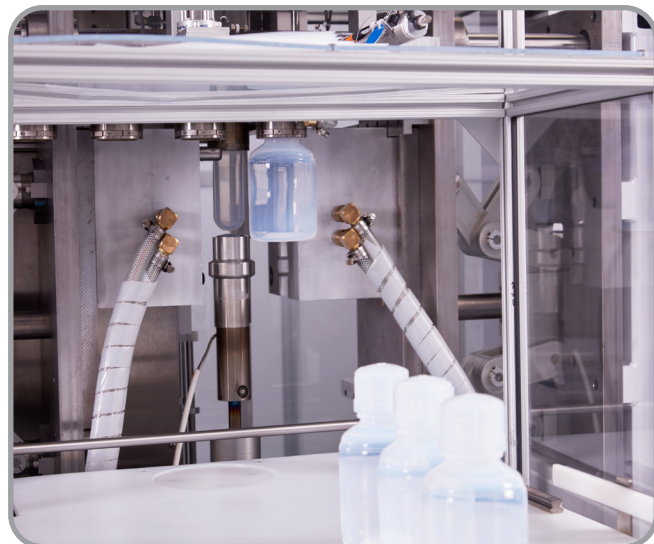
Class 7 クリーンルームでのSavillex Lab Bottle の製造
