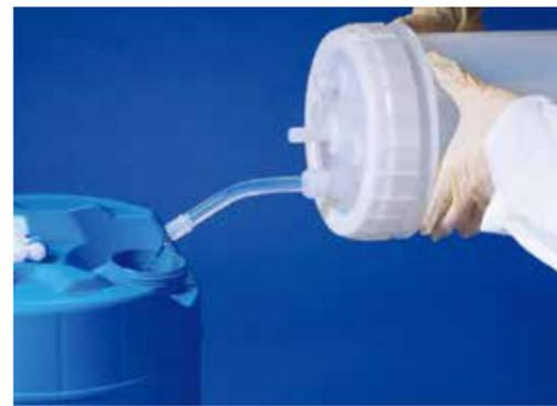
■ 蓋を開けることなく注出ポートから安全に洗浄液を注出できます。転倒時に注出ポートからの液漏れを防止するキャップも付属しています。
